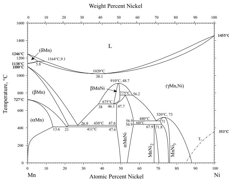
**Fig. 1** Mn-Ni phase diagram
